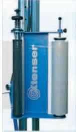
Diese Maschine ist ausgerüstet mit einem Bremsrollen-Hubschlitten und einer Spannungsregelung für die Folie. Die Maschine arbeitet mit jeder Art von Folie. Es ist dabei keine Stromversorgung notwendig, da sie komplett mechanisch arbeitet.
